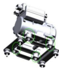
支架+双层减震 (8个减震垫)
